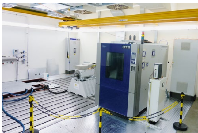
❶ Blick in den Prüfraum mit Synchronmaschinensystem und Klimakammer
